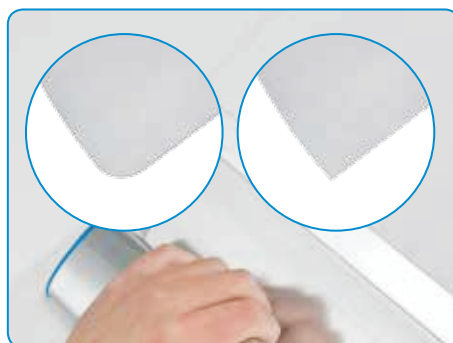
0,3 mm debela lopatica z zaobljenimi robovi za bolj tekoče glajenje in manj naknadne obdelave 0,5 mm debela lopatica z ravnimi koti za brušenje, npr. apneno-cementnega in armiranega ometa
