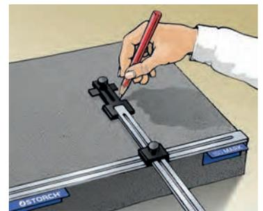
4. Übertragung der Maße auf die Dämmplatte
