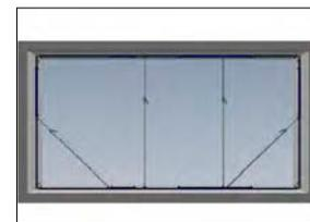
Raumabtrennungen mit Basis-Set: bis zu 3,80 m Höhe x 4 m Breite oder bis 2,70 m Höhe x 5,30 m Breite
