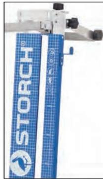
Schwenkbare Anlehstütze für sicheren Stand des Anlehngerätes
