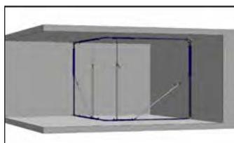
Eckabtrennungen mit Basis-Set: bis 2,70 m Höhe x 3,40 m Breite x 2,15 m Tiefe
