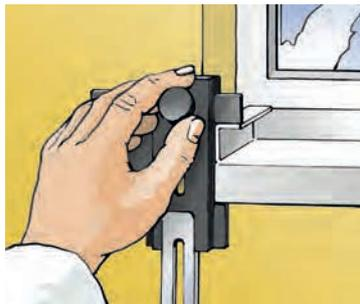
3. Festlegung der Überlappung zwischen Fensterbank-Oberkante und Dämmmaterial
